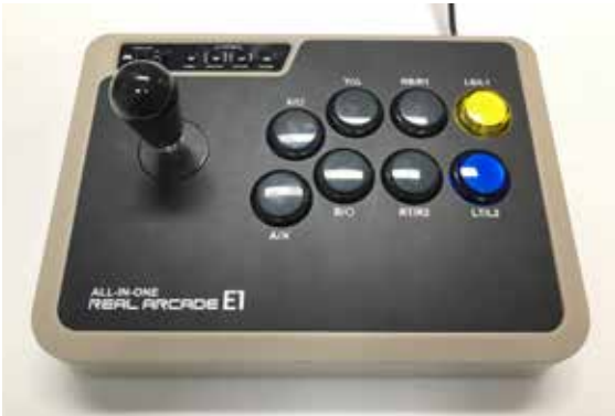
삼덕사 309F레버 및 삼덕사 SDB-201C 버튼으로 교체한 모습
